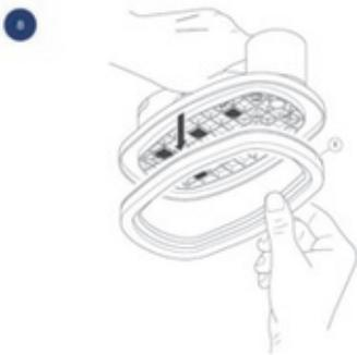
1. Ziehen Sie die Schaumstoffdichtung heraus.
